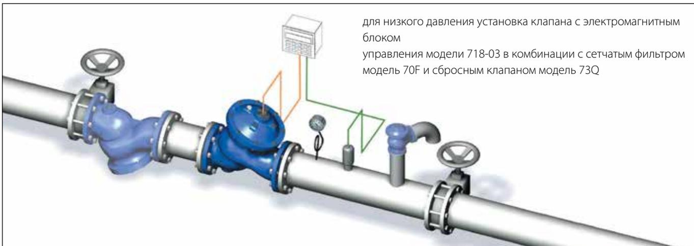
для низкого давления установка клапана с электромагнитным блоком управления модели 718-03 в комбинации с сетчатым фильтром модель 70F и сбросным клапаном модель 73Q
