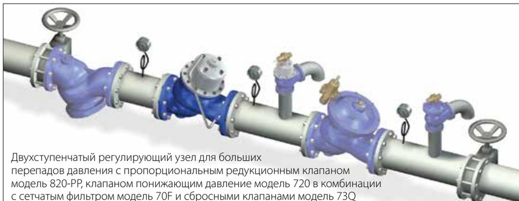
Двухступенчатый регулирующий узел для больших перепадов давления с пропорциональным редукционным клапаном модель 820-PP, клапаном понижающим давление модель 720 в комбинации с сетчатым фильтром модель 70F и сбросными клапанами модель 73Q
