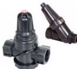
Válvulas reductoras de presión ajustables, de acción directa, con un diafragma plegable que aísla al mecanismo de todo contacto con el flujo y minimiza la fricción para un control preciso y fiable.
