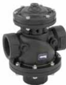
Válvulas hidráulicas de cámara doble para el retrolavado de filtros con unidad de actuador desmontable, cierre hermético con baja presión y suavidad en el cambio de dirección del flujo.
