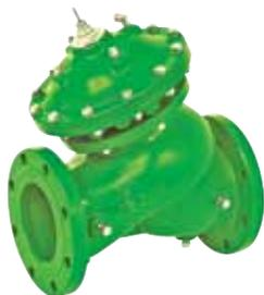
Válvulas de control PN25 de cámara doble, con unidad de actuador desmontable en una sola pieza y accionamiento hidráulico para la apertura y el cierre.
