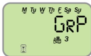
**Por ejemplo: en la pantalla de arriba, la válvula 3 funcionará simultáneamente con la válvula 2 según lo programado para la válvula 2.**
