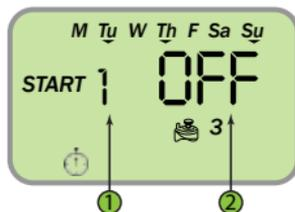
1. Utilice las teclas  $\blacktriangledown$   $\blacktriangle$  para cambiar la hora de inicio del riego (2).
