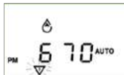
Измерение высокого расхода
