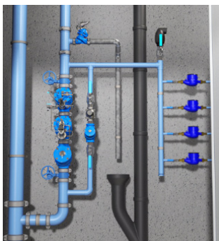
Hình 4.7 - Hệ thống giảm áp trên sàn
