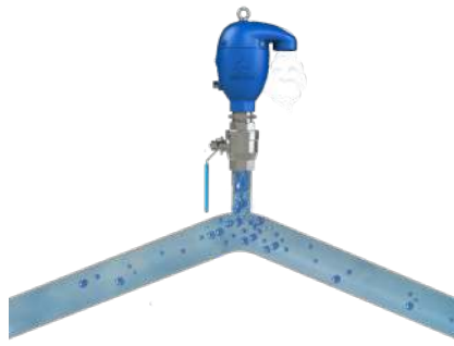
Hình 2.2 - Giải phóng các túi khí bị kẹt lại
