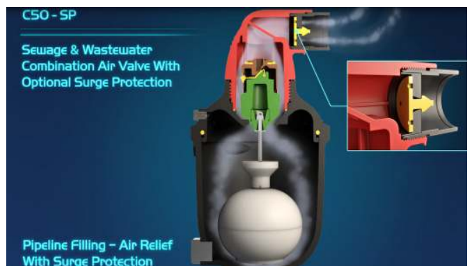
Hình 3.6 - C50, Hệ thống xả khí với tính năng Bảo vệ Chống Tăng áp (SP) dựa trên Đĩa bít.
