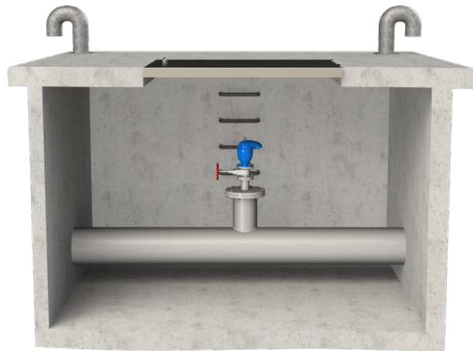
Hình 10.3 - Lắp đặt ngâm
