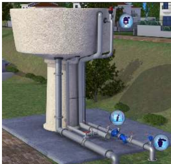
Hình 4.5 - Bể chứa nước trên cao
