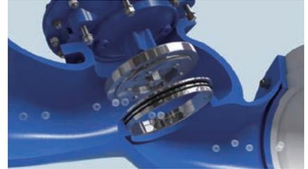
วาล์ว Bermad 700 SIGMA มีโครงสร้าง Double chamber เป็นมาตรฐาน สามารถป้องกันแผ่นไดอะแฟรมได้ ไม่จำเป็นต้องใช้สปริงในขั้นตอนแรกของการปิดวาล์วและง่ายต่อการเปลี่ยนการใช้งานวาล์วและฟังก์ชันต่างๆในพื้นที่ คุณสมบัติมาตรฐานนี้ช่วยเพิ่มประสิทธิภาพให้การใช้งานได้ดียิ่งขึ้น โดยเฉพาะใช้งานในสภาวะแรงดันต่ำได้ดีมาก
