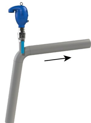
ภาพที่ 5.3 - ท่อลาดขึ้นที่ความชันลดลง
