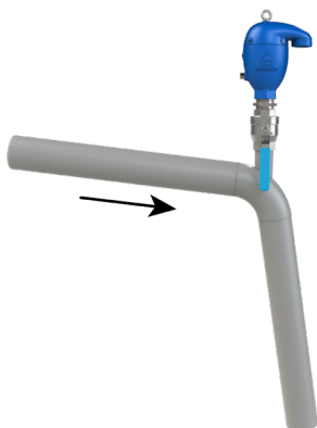
ภาพที่ 5.2 - ท่อลาดลงที่ความชันที่เพิ่มขึ้น
