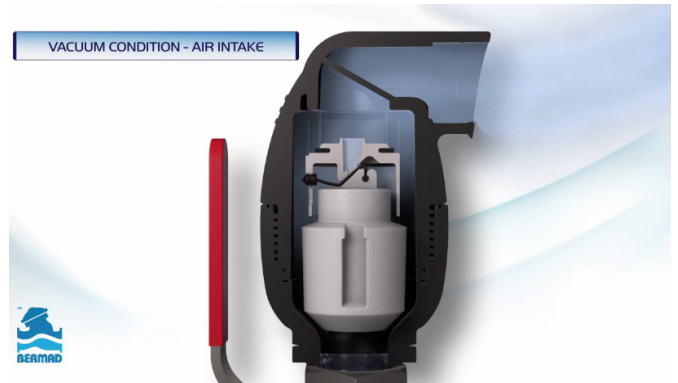
ภาพที่ 3.4 C30 การเติมอากาศในสภาวะสูญญากาศ คลิกเพื่อชมแอนิเมชันหลักการทำงานของ C30
