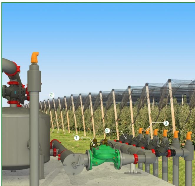
[1] BERMAD Model IR-423-XZ mempertahankan tekanan hilir Saringan, memastikan tekanan Penguras yang memadai, mencegah pengosongan saluran, mengendalikan pengisian sistem hilir & mengurangi tekanan pengoperasianya
