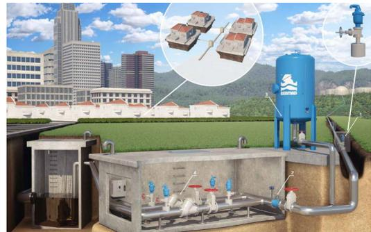
Gambar 4.6 – Sistem pembuangan limbah kota
