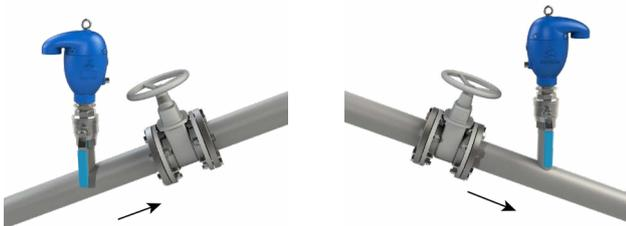
Gambar 5.10 – Katup isolasi pada jalur upslope/ downslope
