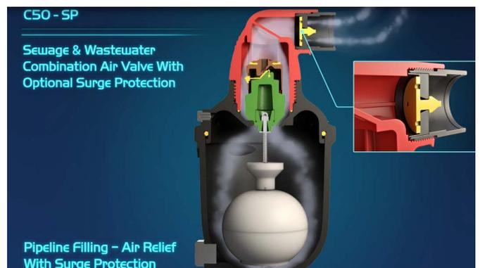
Gambar 3.6 – C50, Pelepasan udara dengan Perlindungan Arus Balik (SP) berdasarkan Segel.
