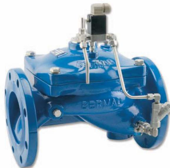
A Válvula Controlada por Solenoide Modelo VA-145 é uma válvula de controle operada hidráulicamente e acionada por diafragma que abre completamente ou fecha em resposta a sinais elétricos.
