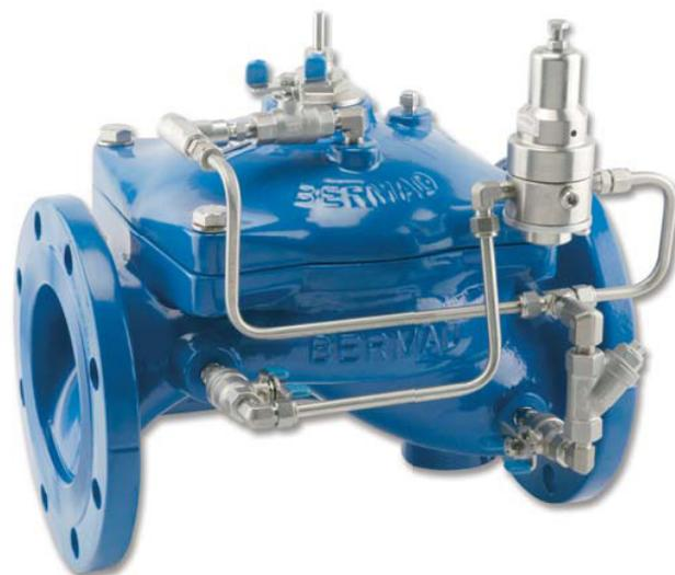
A Válvula Redutora de Pressão modelo VA-101 é uma válvula de controle hidráulica acionada por diafragma que reduz a pressão mais elevada a montante de volta à pressão menos elevada constante a jusante, independentemente da flutuação na demanda ou de variação na pressão a montante.
