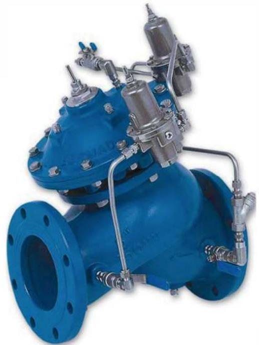
A Válvula Sustentadora e Redutora de Pressão modelo VA-604 é uma válvula de controle hidráulico acionada por diafragma com duas funções independentes. Ela sustenta pressões predefinidas mínimas a montante, independentemente de flutuação na vazão ou de variação na pressão a jusante, além de evitar a elevação da pressão a jusante acima dos ajustes máximos, independentemente de flutuação na vazão ou de pressão excessiva a montante.
