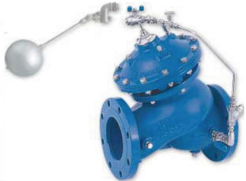
A Válvula de Controle de Nível Modelo VA-621 com boia horizontal de modulação é uma válvula controlada hidráulicamente, acionada por diafragma, que controla o abastecimento do reservatório para manter o nível de água constante, independentemente da demanda.
