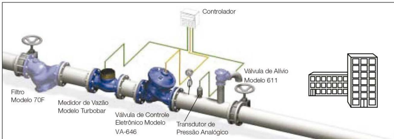
O registro e a análise de dados dos parâmetros de valores da rede de distribuição permitem estabelecer uma função para o ajuste da pressão em tempo real, de acordo com a demanda do sistema. Os transdutores de vazão e pressão transmitem continuamente ao controlador, que reage ajustando a válvula Modelo VA-646 de acordo com a função pré-estabelecida.
