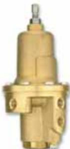
Questa valvola pilota integra tutte le principali funzioni di controllo a 2 vie in un unico prodotto. Una Valvola a Spillo integrata nel pilota agisce come orifizio sulla pressione di monte e come valvola per il controllo della velocità di attuazione della valvola.
