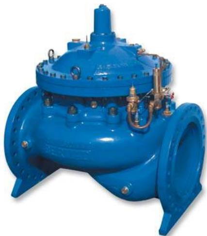
Les vannes de régulation série 700 BERMAD 24", 28", 30", 32" et 36" sont des vannes à membrane, actionnées hydrauliquement, forme du corps en ligne. La vanne est composée de deux composants principaux : corps et actuateur. L'actuateur est démontable du corps en une seule pièce. Il est composé de deux chambres de contrôle – supérieure et inférieure. L'actuateur peut être configuré sur site à simple ou à double chambre suivant la fonction de régulation demandée.
